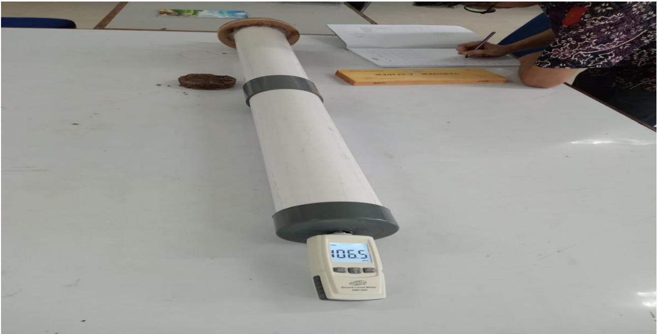
Gambar 10 Set alat uji berupa tabung impedansi dan sound level meter.
